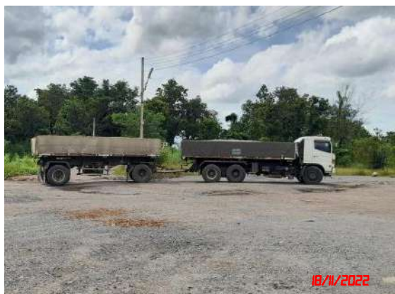
รูปที่ 13 การใช้ผ้าปิดคลุมกระบะรถบรรทุกก่อนออกนอกพื้นที่โครงการ
